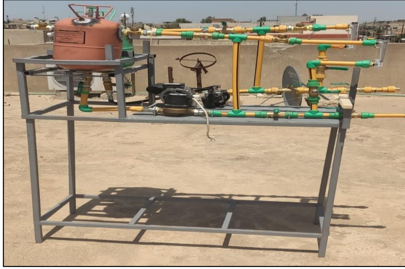
الشكل 5: منظومة الخزان قبل التغليف بالمادة العزلة
