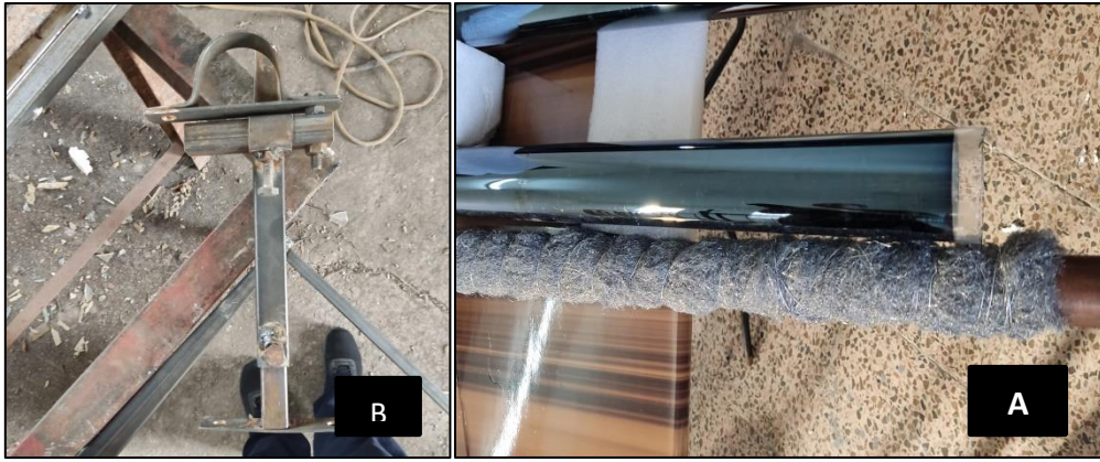
الشكل 4: A- المستقبل الذي يتكون من انبوب نحاس مغلف بليف المنيوم، والغطاء الزجاجي المطلي بالكروم الاسود. B- قاعدة المستقبل
