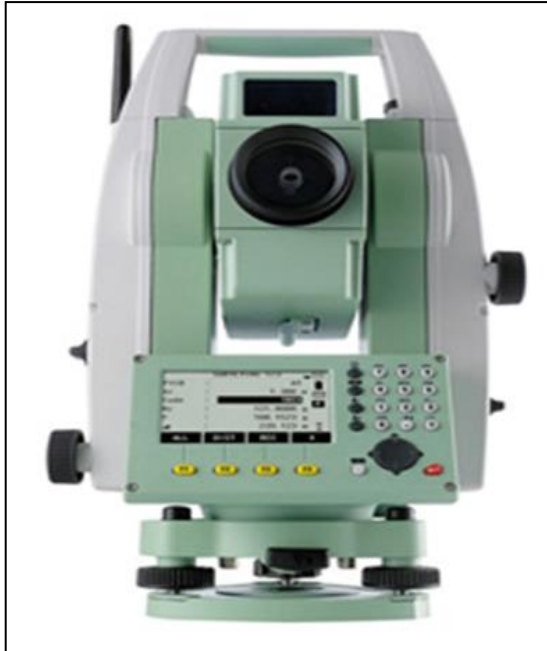
اللوحة (a:2) الايسر جهاز المحطة المتكاملة (T.S 06 ) دقته (1") بالزوايا و (1mm) بالمسافات والايمن جهاز (GPS 1230 ) المساحي دقته (2-5 سم).
