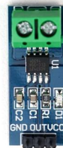
الشكل (5): مقياس الكتروني لقياس التيار الكهربائي
